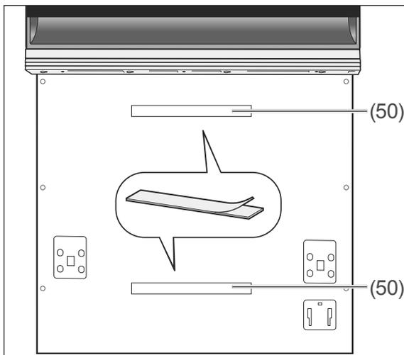
7. Kleben Sie die Klettbänder mit der abgezogenen Schutzfolie mittig auf die eingelassenen Bereiche auf der Gerätetür.
