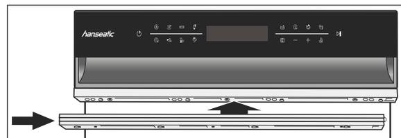
5. Wenn Sie mehr als 1 Zierleiste benötigen, drehen Sie die untere Zierleiste um und schieben Sie sie auf die übrigen. So verschwinden die „Füßchen“ und die Oberflächen sind plan.
