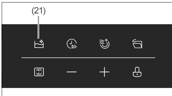
2. Halten Sie die Programmtaste
