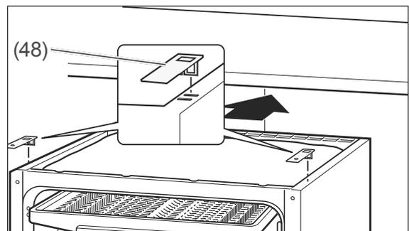
1. Stecken Sie beide Montagewinkel (48) in die vorderen Schlitze an der oberen Seite des Geräts, um später das Gerät an die Arbeitsplatte anschrauben zu können.
