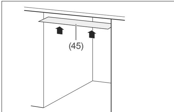
4. Kleben Sie die beiliegende Schutzfolie (45) auf die Unterseite der Arbeitsplatte. So vermeiden Sie Schäden an der Arbeitsplatte aufgrund heißer Dämpfe, die bei geöffneter Gerätetür aus dem Gerät strömen.
