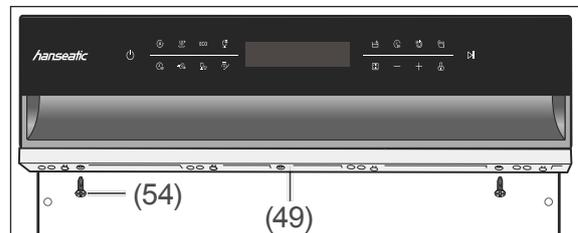
4. Wenn Sie nur 1 Zierleiste benötigen, sägen Sie die 4 herausragenden „Füßchen“ ab, klemmen Sie die Zierleiste unter die Bedienblende und fixieren Sie sie mit den beiden Senkkopfschrauben (54).
