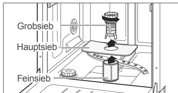
Überprüfen Sie nach jedem Spülgang das Grobsieb, das Hauptsieb und das Feinsieb, und entfernen Sie ggf. Speisereste und Fremdkörper:
