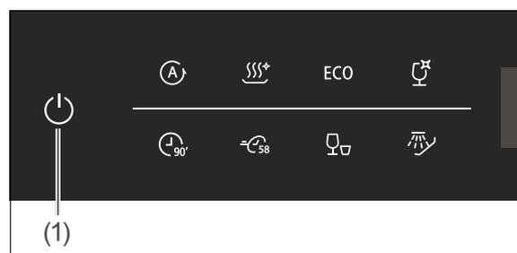
3. Falls das Gerät eingeschaltet ist, schalten Sie es mit der Taste (1) aus.
