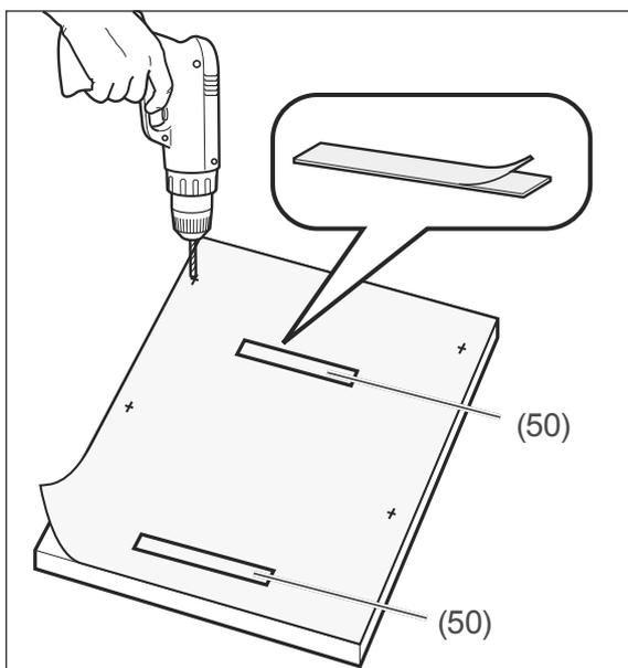
10. Legen Sie die mitgelieferte Bohrschablone so auf die Rückseite der Möbelfrontplatte, dass die Bohrschablone und die Möbelfrontplatte oben bündig abschließen.
