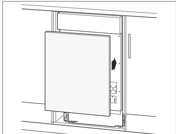
14. Fixieren Sie die Möbelfrontplatte mithilfe der Klettbänder (50) an der Gerätetür, halten Sie sie fest, und öffnen Sie vorsichtig die Gerätetür.
