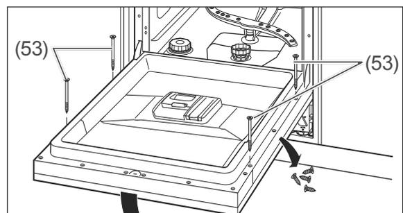
15. Entfernen Sie die 4 Schrauben an der Innenseite der Gerätetür. Schrauben Sie die Möbelfrontplatte an diesen Positionen mithilfe der beiliegenden 4 Schrauben (53) fest.
