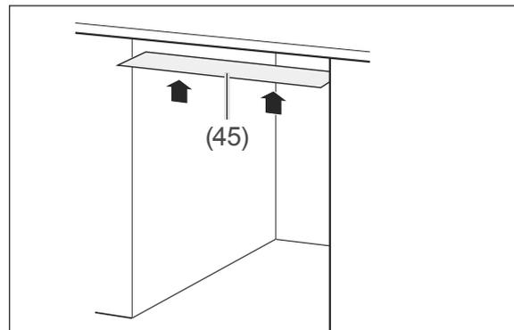
3. Kleben Sie die beiliegende Schutzfolie (45) auf die Unterseite der Arbeitsplatte. So vermeiden Sie Schäden an der Arbeitsplatte aufgrund heißer Dämpfe, die bei geöffneter Gerätetür aus dem Gerät strömen.
