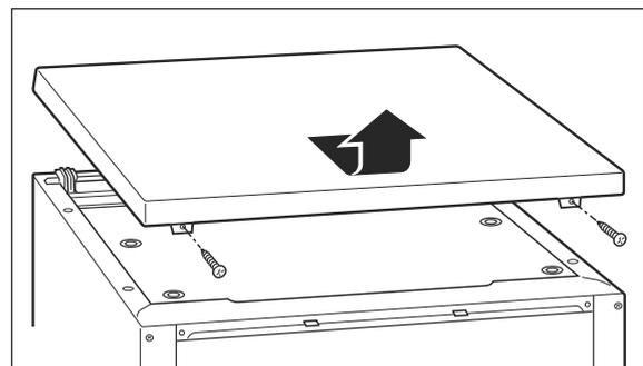
3. Lösen Sie die beiden Schrauben auf der Rückseite der Abdeckplatte und nehmen Sie diese ab.
