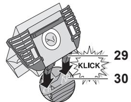
7. Gehäusedeckel wieder verschließen. Dabei darauf achten, dass der Staubbeutel nirgends eingeklemmt wird.
