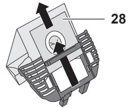
5. Einen neuen Staubbeutel in den Staubbeutelhalter schieben.
