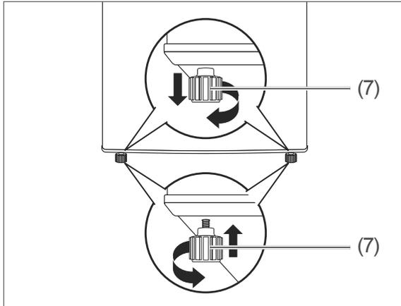
5. Gleichen Sie Unebenheiten im Untergrund mithilfe der beiden vorderen Schraubfüße (7) aus.
