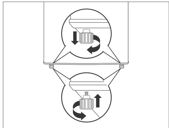
2. Gleichen Sie Unebenheiten im Untergrunds mithilfe der beiden vorderen Schraubfüße aus.
