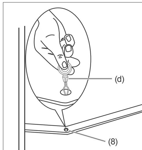
12. An der Rückwand des Kühlbereichs, oberhalb der Gemüseschublade befindet sich der Tauwasserablauf (8). Reinigen Sie ihn regelmäßig mit dem Reinigungswerkzeug (d).
