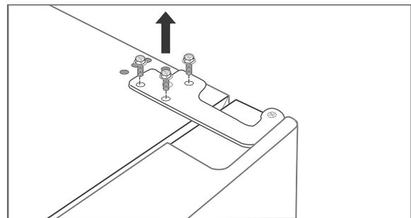
3. Schrauben Sie die 3 Schrauben am oberen Scharnier heraus und nehmen Sie das Scharnier ab.
