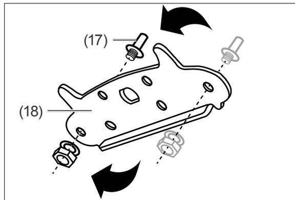
13. Versetzen sie den Scharnierbolzen wie oben dargestellt.
