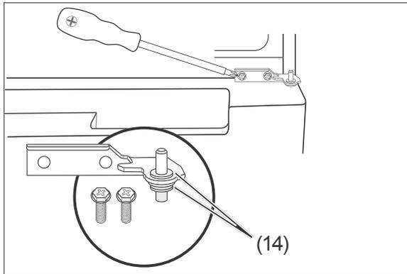
6. Schrauben Sie das mittlere Scharnier ab und nehmen Sie es heraus. Achten Sie dabei auf die Kunststoff-Scheiben (14). Sie müssen später wieder an der gleichen Position angebracht werden.
