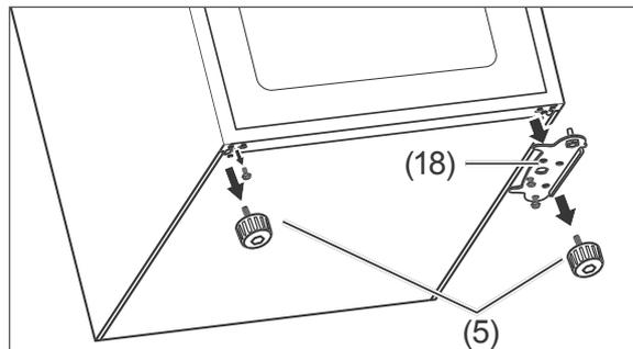
10. Kippen Sie das Gerät leicht nach hinten gegen eine Wand, sodass das untere Scharnier (18) zugänglich ist.
