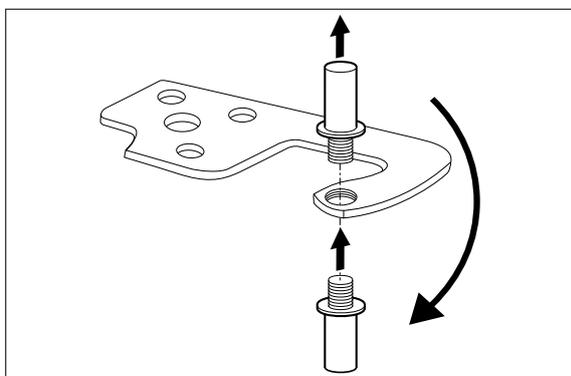
17. Schrauben Sie den Scharnierbolzen mithilfe einer Zange heraus und schrauben Sie ihn auf der anderen Seite der Scharnierplatte wieder hinein.
