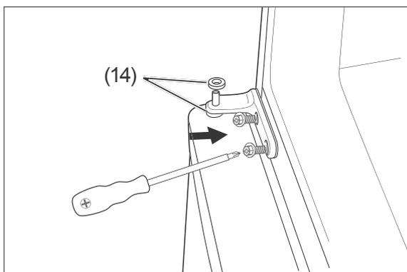
16. Setzen Sie das mittlere Scharnier an der neuen Position wieder ein. Achten Sie dabei auf die beiden Kunststoffscheiben (14). Schrauben Sie das Scharnier fest.
