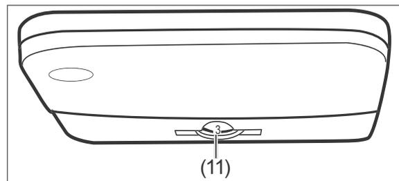
Der Temperatur-Reglers (11) dient auch zum Ein- und Ausschalten des Geräts. Er befindet sich oben im Kühlbereich.
