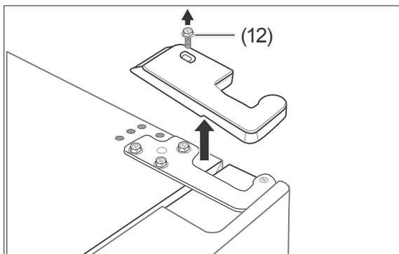
2. Schrauben Sie die Schraube (12) heraus. Nehmen Sie dann die Scharnierblende ab.
