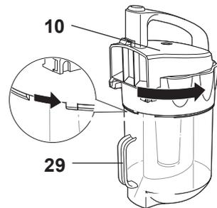
4. Staubbehälter-Deckel **10** nach oben abziehen.
