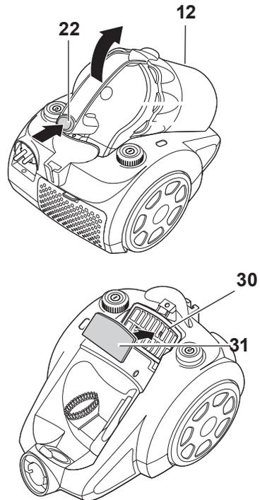
Wenn der Motorschutzfilter beschädigt sein sollte oder nicht mehr ausreichend gereinigt werden kann, muss er gegen neue ausgetauscht werden (Bezugsquelle siehe S. 29 „Unser Service“).
