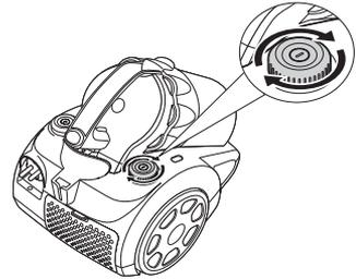
5. Bei Bedarf die Saugkraft mithilfe des Nebenluftventils **25** verringern. Die Abdeckung des Nebenluftventils lässt sich stufenlos verschieben.
