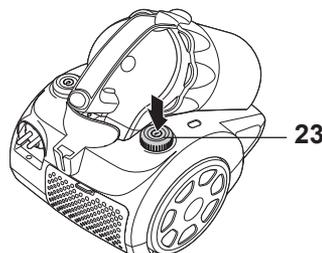
4. Den Fußschalter Ein /Aus **23** im Uhrzeigersinn drehen, um die Saugkraft stufenlos zu erhöhen. Den Fußschalter entgegen dem Uhrzeigersinn drehen, um die Saugkraft stufenlos zu verringern.
