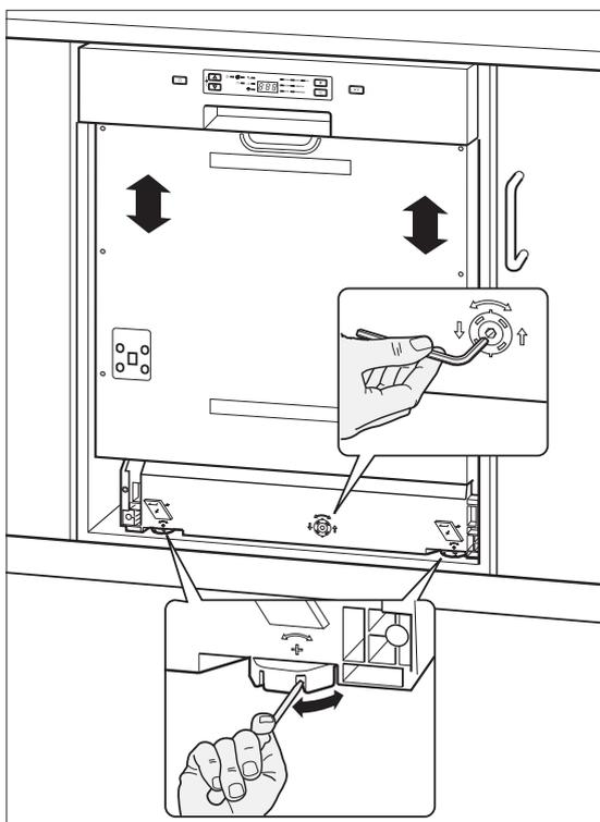
3. Gerät mithilfe der Schraubfüße waagrecht ausrichten. Dabei die Füße so weit wie möglich herausschrauben. Das Gerät muss bis an den oberen Nischenrand ragen, um beim Öffnen der Tür nicht nach vorne zu kippen.
