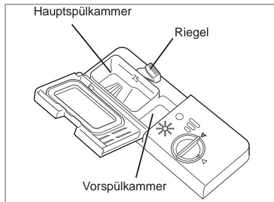
1. Riegel an Spülmittelkammer zurückziehen. Der Deckel springt auf und die beiden Spülmittelkammern werden sichtbar.
