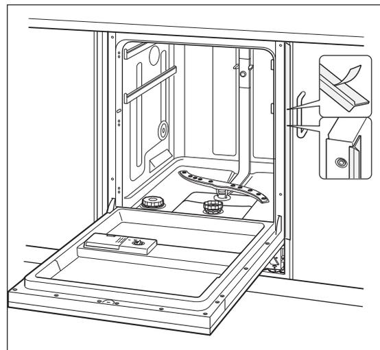
1. Die Schutzfolien vom Klebeband der Kunststoffprofile abziehen.
