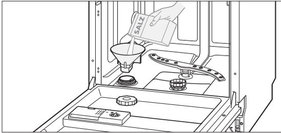
3. Trichter **29** in die Salzkammer setzen.
