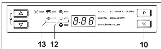
Wenn Sie nur den Oberkorb oder nur den Unterkorb beladen haben, können Sie mit der Taste **10** einstellen, ob das Gerät nur den oberen oder nur den unteren Sprüharm verwendet oder beide zugleich. Welcher Sprüharm aktiviert ist, erkennen Sie an den Kontroll-LEDs **12** und **13**.
