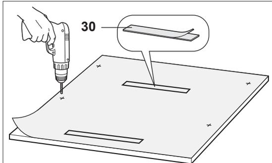
11. Die Schutzfolie von den beiden anderen Klettstreifen **30** abziehen und die Streifen mithilfe der Schablone auf die Möbelfrontplatte kleben.
