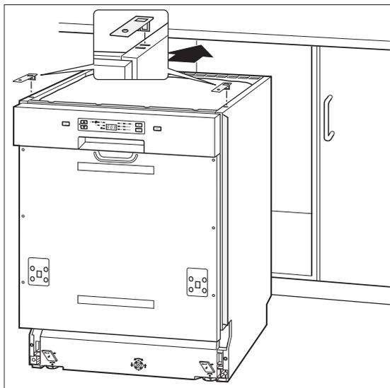
2. Die beiden Haken **35** oben in die Seitenwände des Geschirrspülers stecken. Sie dienen zur Befestigung des Geräts an der Arbeitsplatte. Gerät anschließen und in die Nische schieben.
