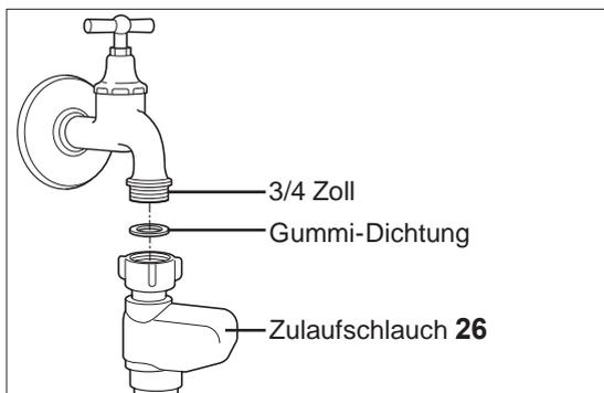
1. Überwurfmutter des Sicherheitsventils **handfest** an den Wasserhahn anschrauben.
