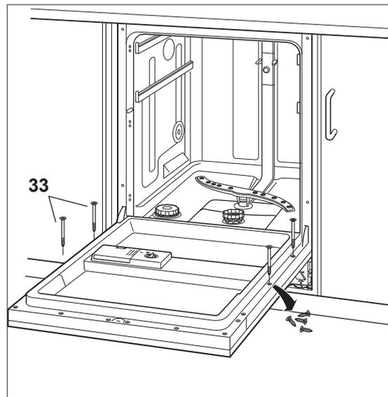
14. Die 4 Schrauben an den oben abgebildeten Positionen herausschrauben und die Möbelfrontplatte mit den 4 beiliegenden Schrauben **33** zusätzlich anschrauben.
