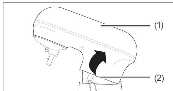
2. Kippen Sie den Entriegelungshebel (2) nach oben. Der Maschinenarm (1) klappt hoch.
