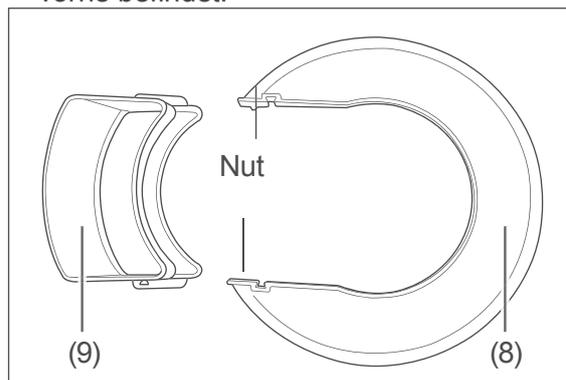
2. Setzen Sie die Einfüllhilfe (9) in die Nut des Schutzdeckels.
