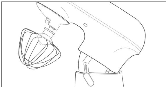
3. Stecken Sie das gewünschte Rührelement ((10), (11) oder (12)) von unten auf die Rührwelle (6). Führen Sie dabei die Nut des Rührelements über die Nase des Passstiftes.
