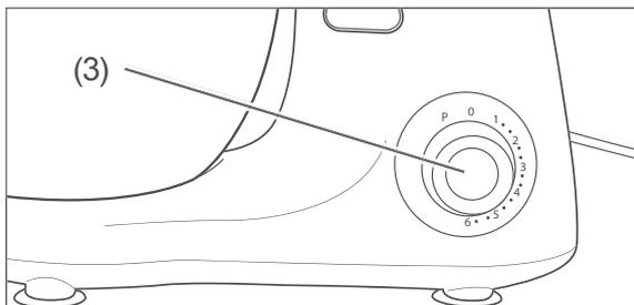
Mit dem Drehregler (3) starten bzw. stoppen Sie das Gerät und bestimmen gleichzeitig die Geschwindigkeit.
