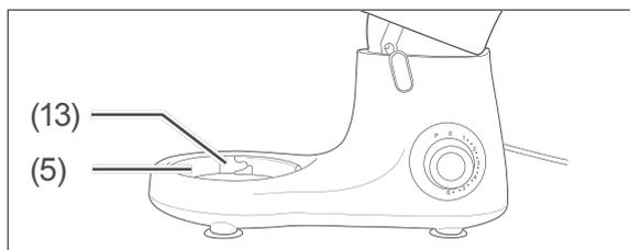
1. Setzen Sie die Rührschüssel (7) so in die Aufnahme (5), dass die drei Nasen unten an der Rührschüssel in die Aussparungen in der Aufnahme passen.
