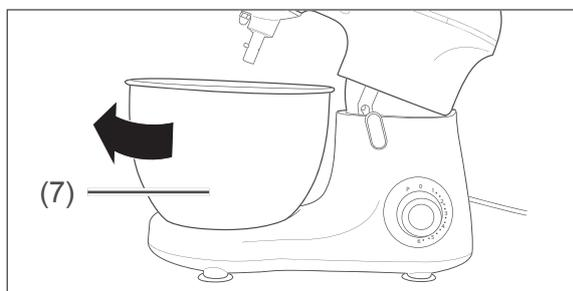
2. Drehen Sie die Rührschüssel im Uhrzeigersinn, bis sie einrastet und fest sitzt (über den Widerstand hinaus).
