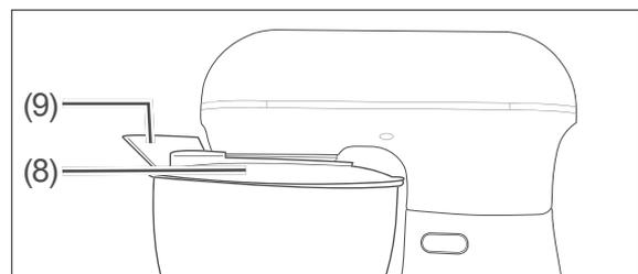
2. Entnehmen Sie vorsichtig die Einfüllhilfe (9) und den Schutzdeckel (8).
