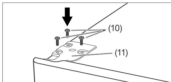
22. Stecken Sie die obere Scharnierplatte (11) auf die Kühlfach für und schrauben Sie sie anschließen mit den drei Kreuzschlitzschrauben (10) fest.
