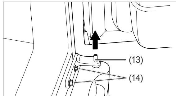
5. Öffnen Sie die Kühlfachtür und heben Sie sie senkrecht nach oben von dem Bolzen des mittleren Scharniers (13) ab. Stellen Sie die Tür beiseite.
