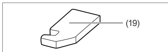
24. Pressen Sie die Scharnierblende (19) auf die Scharnierplatte und die Abdeckplatte in die Löcher auf der gegenüberliegenden Seite.
