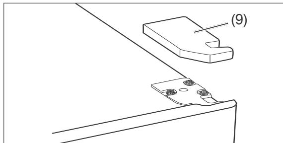
2. Hebeln Sie die Scharnierblende (9) mithilfe eines Schlitz-Schraubendrehers vorsichtig nach oben ab.
