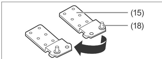
12. Versetzen Sie den Scharnierbolzen (18) wie oben dargestellt.
