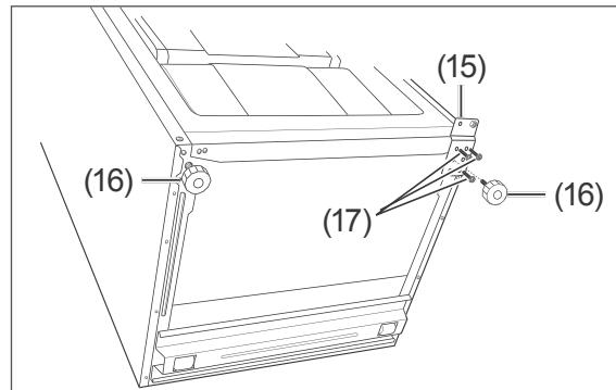
8. Kippen Sie das Gerät so weit nach hinten ( $45^\circ$  max.), dass Sie die vorderen Gerätefüße (16) und die untere Scharnierplatte (15) gut erreichen können.
