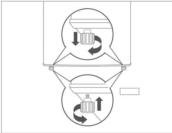
3. Gleichen Sie Unebenheiten des Untergrunds mithilfe der beiden vorderen Schraubfüße aus.
