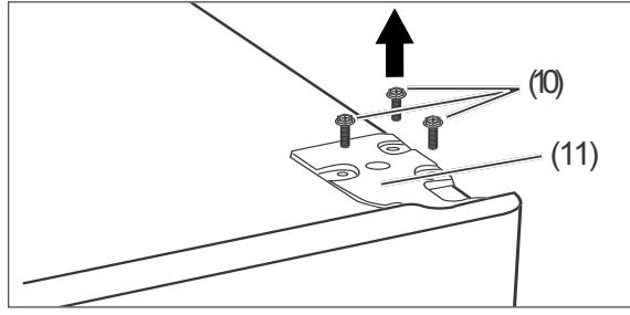
3. Lösen Sie die Schrauben (10) und entfernen Sie die obere Scharnierplatte (11).
