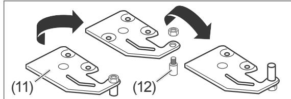
4. Schrauben Sie die Mutter mit einem 10er Schraubenschlüssel vom Scharnierbolzen
