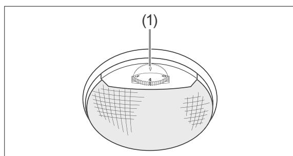
Der Temperaturregler (1) dient auch zum Ein- und Ausschalten des Geräts. Er befindet sich an der Decke des Kühlbereichs.
