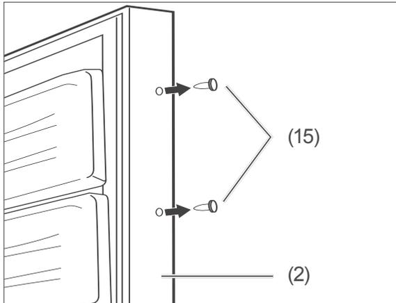
1. Hebeln Sie die beiden Blindstopfen (15) aus der Seite der Gerätetür (2).
