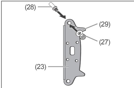
5. Drehen Sie das untere Scharnier (23) um, und schrauben Sie den Scharnierbolzen (28) und den Sprengring (29) wieder an.
