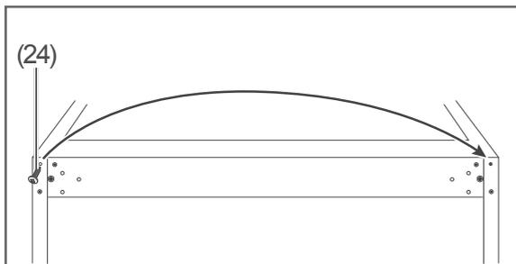
8. Lösen Sie die Schraube (24), und setzen Sie sie an der gegenüberliegenden Seite wieder ein.
