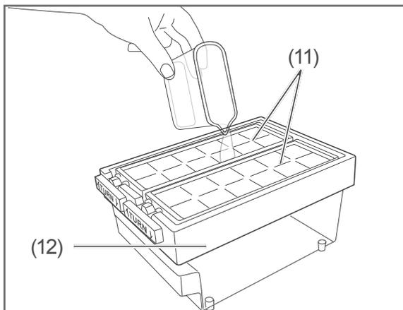
1. Füllen Sie die Eiswürfelformen (11) des mitgelieferten Eiswürfelbereiters (12) zu ca.  $\frac{3}{4}$  mit frischem Trinkwasser, und stellen Sie ihn waagrecht in den Gefrierraum. Benutzen Sie dazu am besten einen Füllbehälter (nicht im Lieferumfang enthalten).
