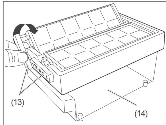
2. Zum Entnehmen von Eiswürfeln drehen Sie die Hebel (13) im Uhrzeigersinn. Die Eiswürfel fallen in den Vorratsbehälter (14).
