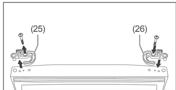
2. Lösen Sie die Schraube am Kunststoffeinsatz (25) der Gerätetür, und nehmen Sie den Kunststoffeinsatz ab.
