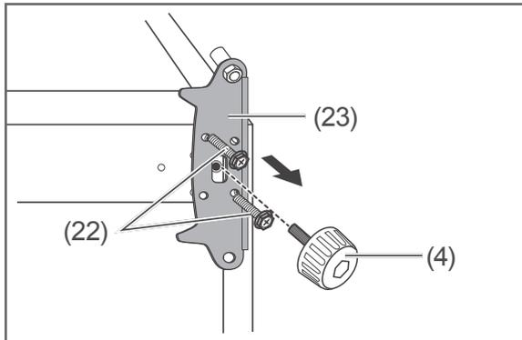
6. Lösen Sie die Schrauben (22) am unteren Scharnier (23), drehen Sie den rechten Schraubfuß (4) heraus, und nehmen Sie das untere Scharnier ab.
