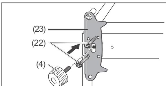
1. Schrauben Sie mit den beiden Schrauben (22) das untere Scharnier (23) links an, und drehen Sie den Schraubfuß (4) wieder ein.
