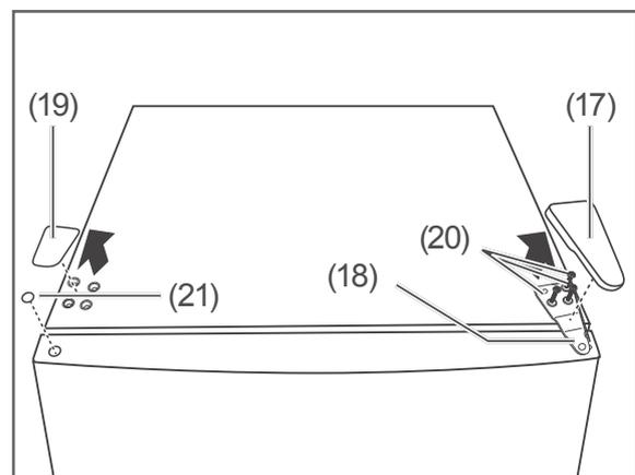
1. Nehmen Sie die Scharnierabdeckung (17) des oberen Scharniers (18) und die gegenüberliegende Abdeckung (19) ab.
