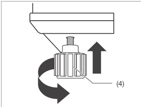
5. Gleichen Sie Unebenheiten im Untergrund mithilfe der beiden vorderen Schraubfüße (4) aus.
