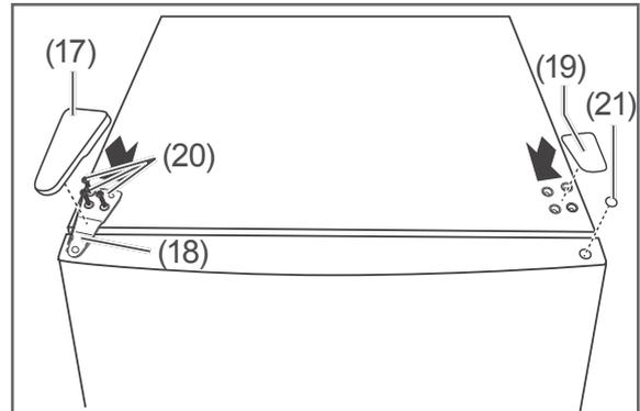
1. Schrauben Sie das obere Scharnier (18) mit den Schrauben (20) fest.
