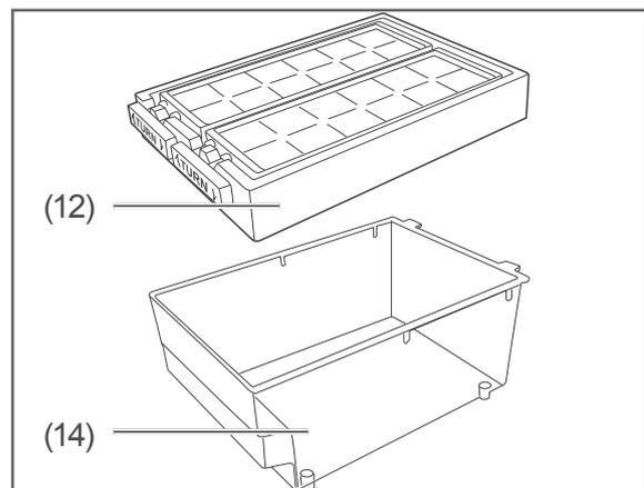
3. Nehmen Sie den Eiswürfelbereiter (12) vom Vorratsbehälter (14) ab, und entnehmen Sie die Eiswürfel. Benutzen Sie dazu am besten eine Eisschaufel (nicht im Lieferumfang enthalten), um Kälteverletzungen zu vermeiden.
