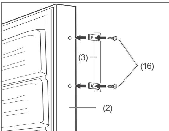
2. Schrauben Sie den Türgriff (3) mit den beiliegenden Schrauben (16) an die Gerätetür (2).
