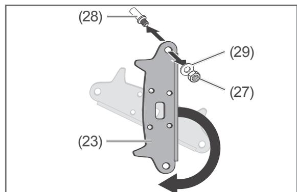
4. Lösen Sie mithilfe des 10er Schraubenschlüssels und einer Zange die Mutter (27) des Scharnierbolzens (28) am unteren Scharnier (23), und nehmen Sie sie zusammen mit dem Sprengling (29) ab.
