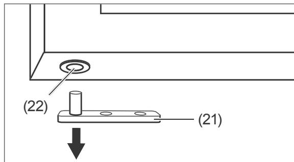
4. Ziehen Sie die Scharnierplatte (21) aus dem Kunststoffeinsatz (22) an der Unterseite der Glastür heraus.
