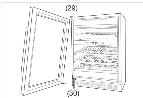
12. Setzen Sie die Glastür zunächst in das obere Scharnier (29) ein, dann auf das untere Scharnier (30). Schließen Sie die Glastür danach.
