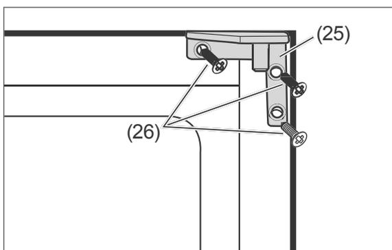
7. Lösen Sie die drei Schrauben (26) des oberen Scharniers (25) und nehmen Sie es ab.
