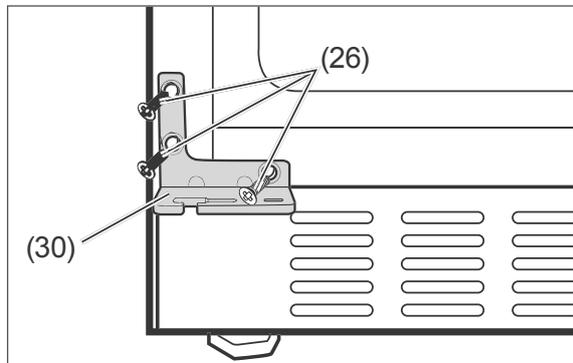
11. Schrauben Sie das mitgelieferte untere Scharnier für den Linksanschlag (30) auf der anderen Seite mithilfe der Schrauben (26) fest.
