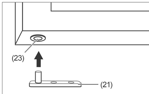
5. Drehen Sie die Glastür um 180° und setzen Sie die Scharnierplatte (21) hier in den Kunststoffeinsatz (23) ein.
