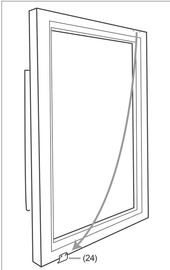
6. Schrauben Sie den Mitnehmer für den Beleuchtungsschalter (24) ab und auf der gegenüberliegenden Seite wieder an (es sind 2 kleine Löcher dafür vorgebohrt). Achten Sie auf die richtige Richtung beim Anschrauben. Stellen Sie die Tür dann beiseite.
