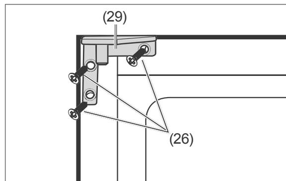
10. Schrauben Sie das mitgelieferte obere Scharnier für den Linksanschlag (29) mit Hilfe der Schrauben (26) fest.
