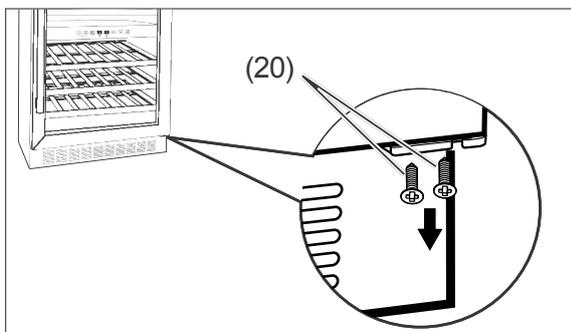
2. Schrauben Sie die beiden Schrauben (20) aus dem unteren Scharnier heraus.
