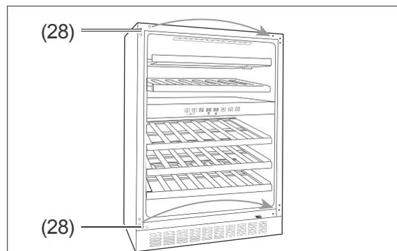
9. Ziehen Sie die 6 Blindstopfen (28) aus den Gewindelöchern oben und unten heraus und setzen Sie sie auf die gegenüberliegende Seite um.
