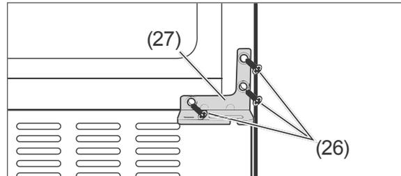
8. Lösen Sie die drei Schrauben (26) des unteren Scharniers (27) und nehmen Sie es ab.
