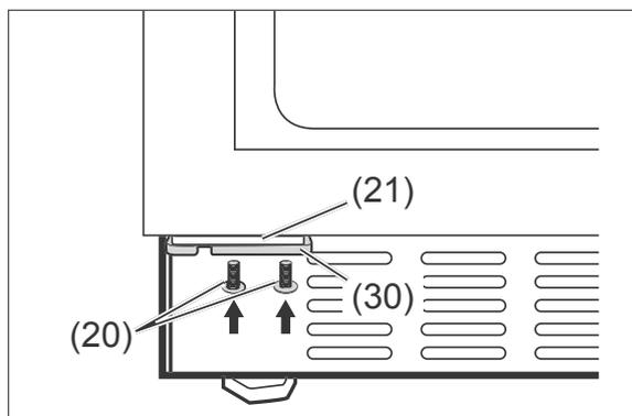
13. Schrauben Sie die Scharnierplatte (21) mit den Schrauben (20) am unteren Scharnier (30) fest.
