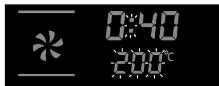
Die Zeitanzeige wechselt auf den eingestellten Wert (hier: 40 Minuten). Die Temperaturanzeige sowie der Doppelpunkt zwischen der Stunden- und der Minutenanzeige blinken.
