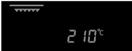
Beim Intensiv-Grillen sind beide Grill-Elemente sowie das obere Heiz-Element des Backofens in Betrieb.
