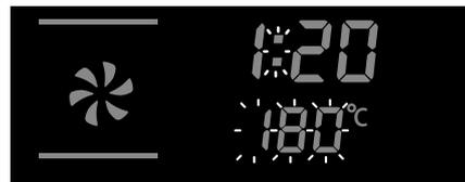
Die Zeitanzeige wechselt auf den eingestellten Wert (hier: 1 Stunde 20 Minuten). Die Temperaturanzeige sowie der Doppelpunkt zwischen der Stunden- und der Minutenanzeige blinken.
