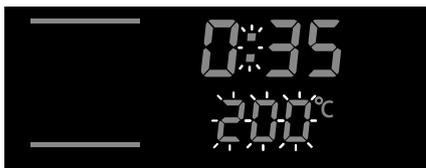
Die Zeitanzeige wechselt auf den eingestellten Wert (hier: 35 Minuten). Die Temperaturanzeige sowie der Doppelpunkt zwischen der Stunden- und der Minutenanzeige blinken.
