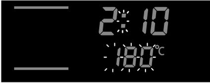
Die Zeitanzeige wechselt auf den eingestellten Wert (hier: 2 Stunden 10 Minuten). Die Temperaturanzeige sowie der Doppelpunkt zwischen der Stunden- und der Minutenanzeige blinken.
